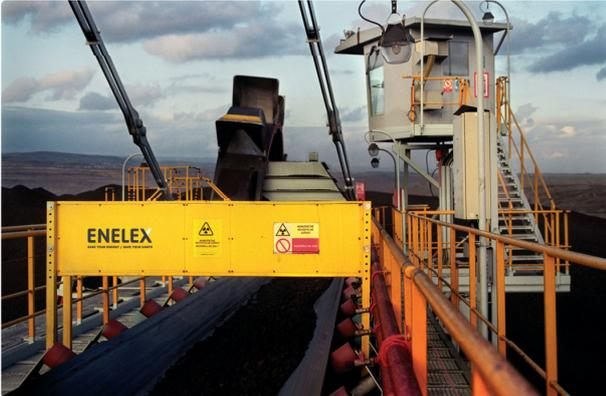
GE 3000 позволяет определять качество и количество угля в режиме онлайн, контролировать зольность угля прямо на движущейся ленте конвейера, дополнительно вычисляя его калорийность и проходящий объём. Применение данного оборудования повысит эффективность добычи угля и позволит оптимизировать объёмы его потребления и, таким образом, значительно снизить расходы.
