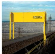
Блок детекции конструировался с упором на максимальную безопасность и надёжность. Измерительный пучок радиоактивного излучения направлен перпендикулярно к ленте конвейера, что никак не ограничивает свободное передвижение людей возле измерительного места.
